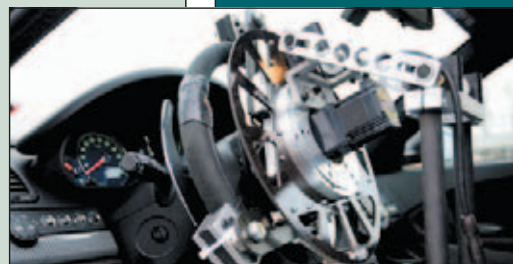
Sopra, il Robot montato sulla Maserati utilizzata nei test di Assogomma. Sotto, prove sulla neve
