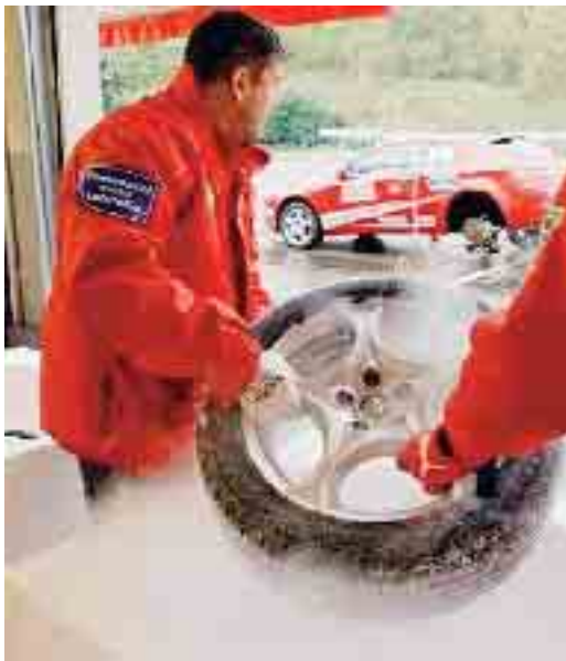
A sinistra: la preparazione con ghiaccio secco delle gomme usate per i test sulla pista di Varano.
