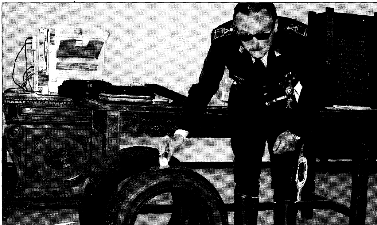
IN ALTO L'APPARECCHIETTO CHE MISURERÀ L'ALTEZZA DEL BATTISTRADA E SOPRA LA DIMOSTRAZIONE DI UN CONTROLLO
